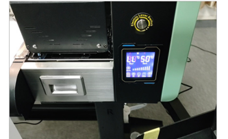
Сенсорна панель. керування: Нагрів платформ, вакуум, підсвітка
